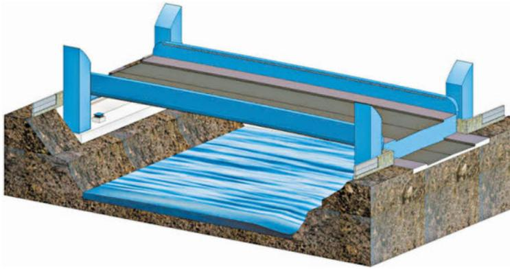
Skizze der Hubbrücke: Sie kann bei Hochwasser um 1,80 Meter angehoben werden – das Wasser staut sich nicht mehr auf. BILD:GDE.MITTESSILL
